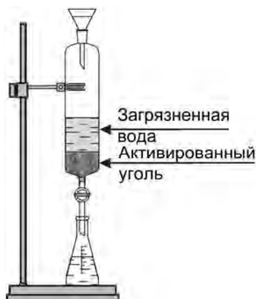
Установка для очистки воды адсорбцией
